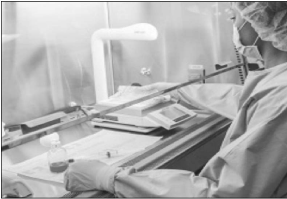
Fig. 8. Campanas biológicas de flujo laminar vertical. Alta protección para evitar riesgos durante la preparación de quimioterapia.
