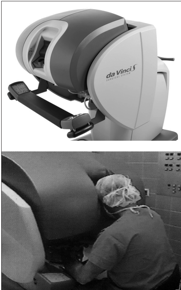
Fig. 1. Consola independiente de la mesa quirúrgica donde el cirujano se sienta y desde que controla los 3 brazos del robot y el brazo que lleva la cámara.
